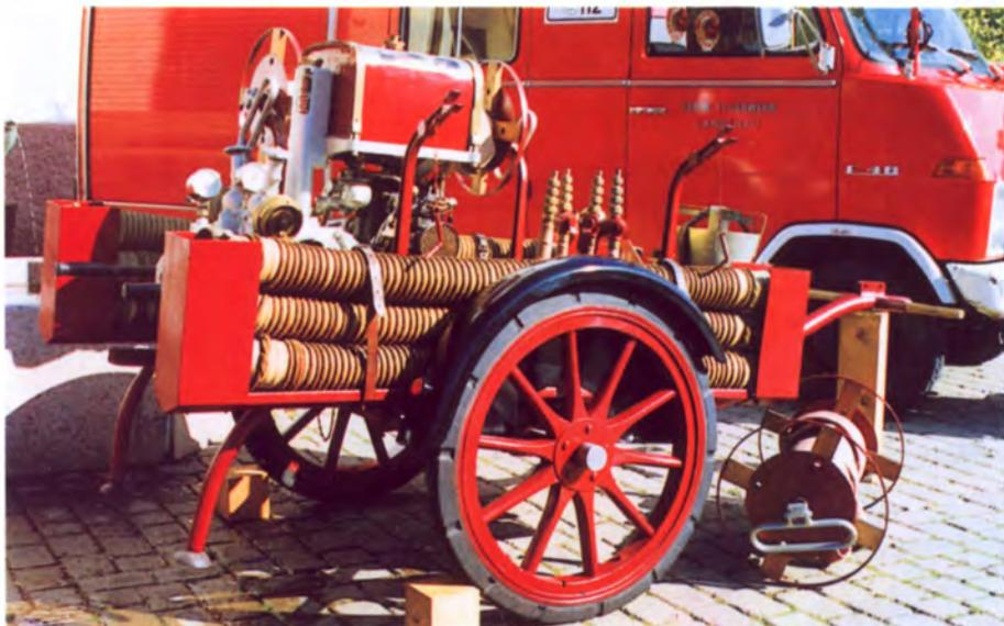
Pumpe: Fa. Balcke 800 l/min, 8 bar
